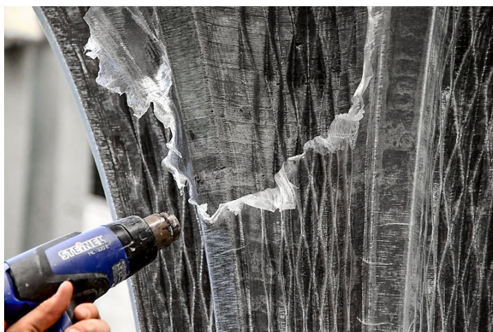
5. ábra: Roncsolásos kizsaluzás (Future Tree “3D printing” | Gramazio Kohler Research / ETH Zürich, 2021)
