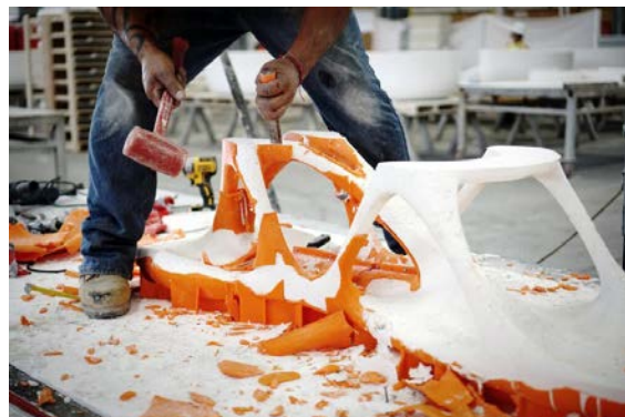
16. ábra: Nyomtatott zsaluzat összeszerelése (ball) és roncsolásos kizsaluzás (jobb) (Jasta, 2021)
