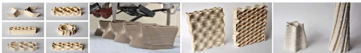
4. ábra – 3D nyomtatással készült kerámia építőelemek [5]
