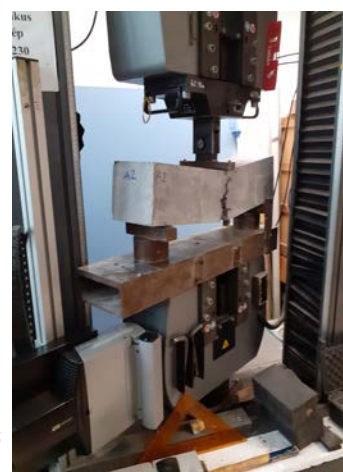
33-34. ábra Terhelő erő - repedéscsúcs megnyílás (CMOD) diagram (baloldalon) és a mérést követően kettétörhetetlennek bizonyult gerendapróbatest (jobbaldalon)
