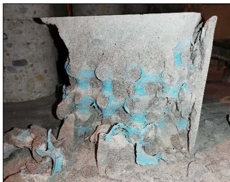
23. ábra: Terráccsal erősített próbakocka törésképe
