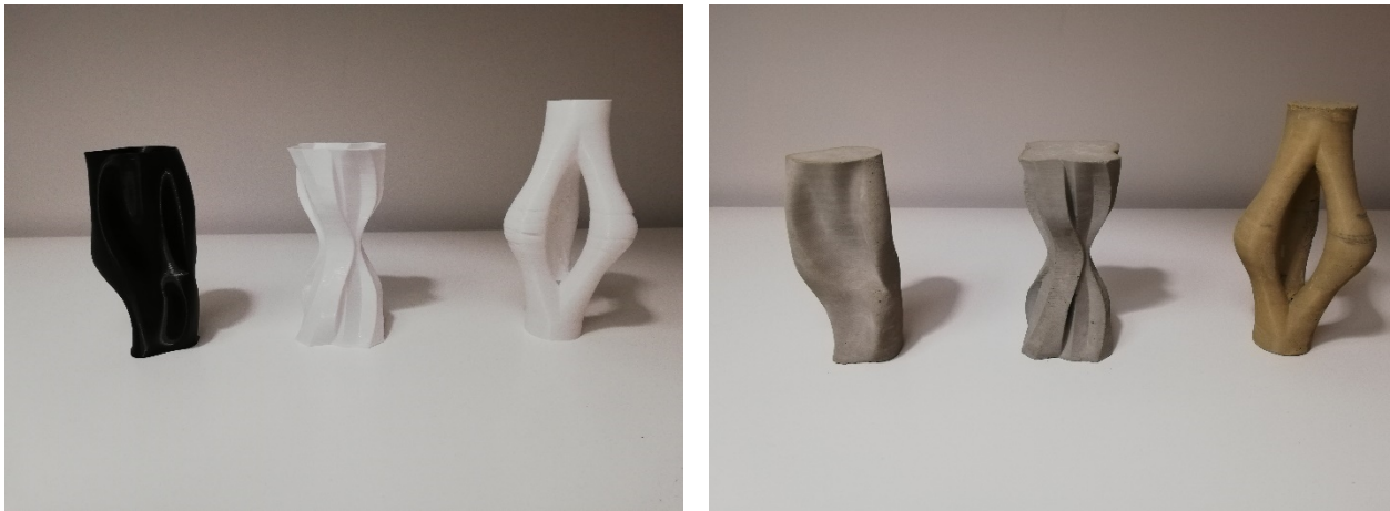
20. ábra: Héj nyomtatással készült szabad formák zsaluzata (ball) és a zsaluzatban kész betontermékek (jobb)
