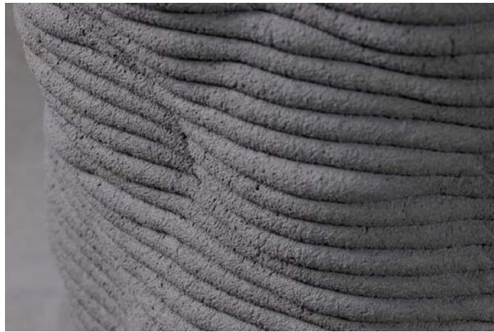
5. ábra: Rétegek megfelelő bedolgozása
