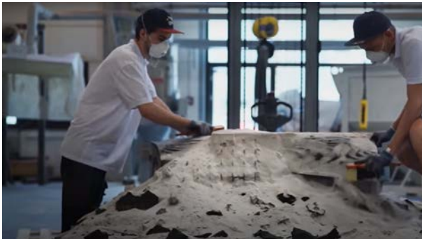
12. ábra: Nyomtatás utáni feleslege homok eltávolítása (ball), elkészült zsaluzat (jobb) (Mashable, 2018) (Pintos, 2021)
