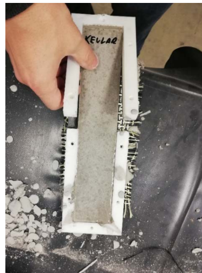
19. ábra: 3D nyomtatott zsaluzatok összeállítása (ball), zsaluzatok szétbontása (jobb)
