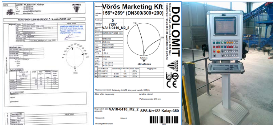
20-22. ábra A megrendelés (baloldalon), a vonalkóddal kinyomtatott gyártási lap (középen), valamint gépkezelő számítógépállomása, mely rögzíti a lézerszenkerral aktuálisan megadott vonalkódot
