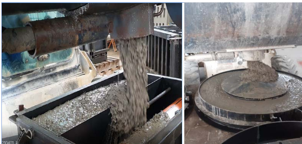
31-32. ábra Az önjáró Bobcat munkagép különböző sablonokba üríti a kívánt adagokat
