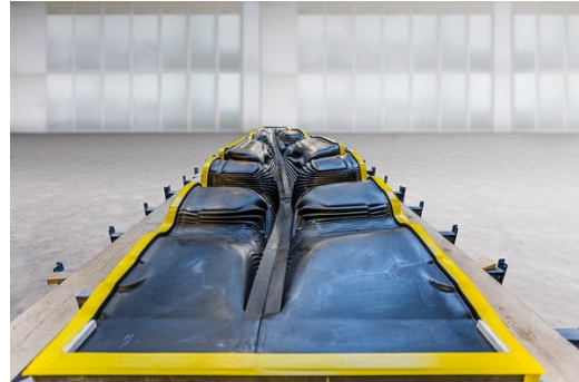
12. ábra: Nyomtatás utáni feleslege homok eltávolítása (ball), elkészült zsaluzat (jobb) (Mashable, 2018) (Pintos, 2021)
