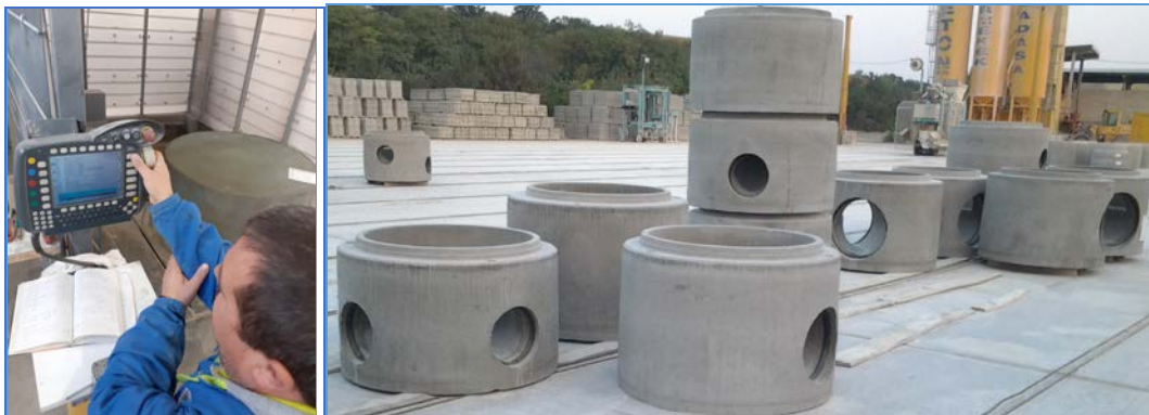
25-26. ábra A KCP készüléken (baloldali ábrán) a gépkezelő csökkenti a marás előtolását, mely főként a jobboldali ábrán látható, hosszú marásidejű aknáknál válik szükségessé
