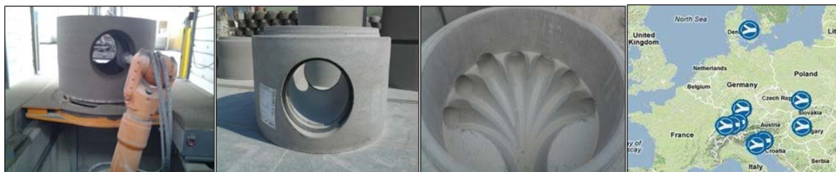
5-8. ábra Az előregyártásban 2009-től terjed a 3D betonmarás (fotók: Spránitz)
