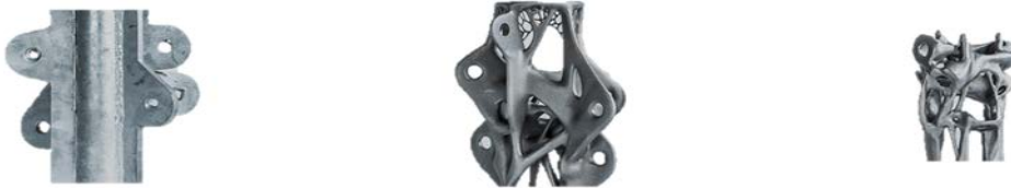
5. ábra – Szerkezeti csomópont optimalizálása: mindhárom csomópont azonos kapcsolati erő felvételére képes (1) hagyományos tervezés és gyártás, (2) és (3) szoftveres optimalizálás és 3D nyomtatás [6]
