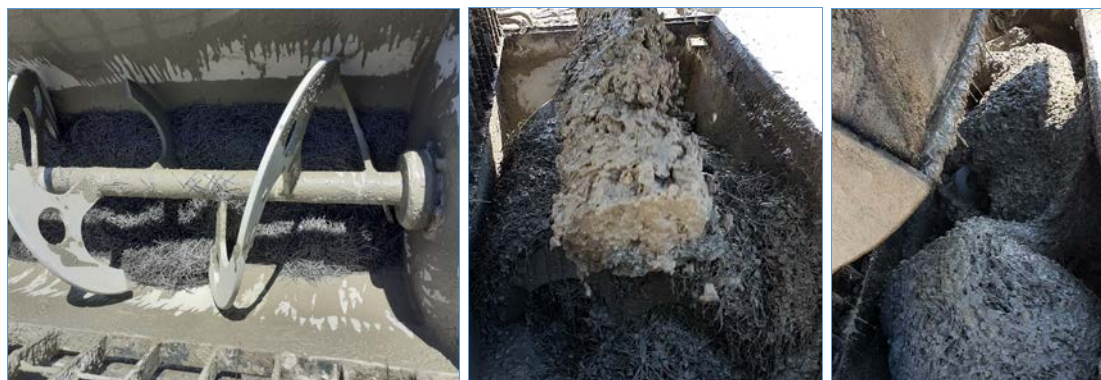
28-30. ábra A Bobcat munkagép keverőadapterével gyorsan homogenizálható a 125 \text{ kg/m}^3 acélszál
