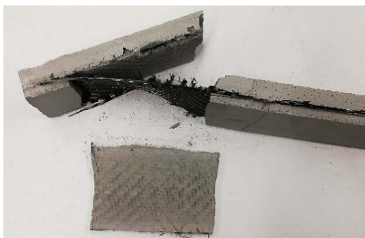
15. ábra: Szövet erősítésű próbatest tönkremenetele
