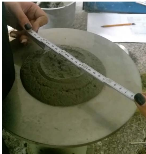
2. ábra: Konzisztencia vizsgálat terülméréssel (saját fotó)
