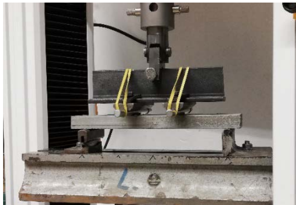
11. ábra: Próbatess terhelési sémája
