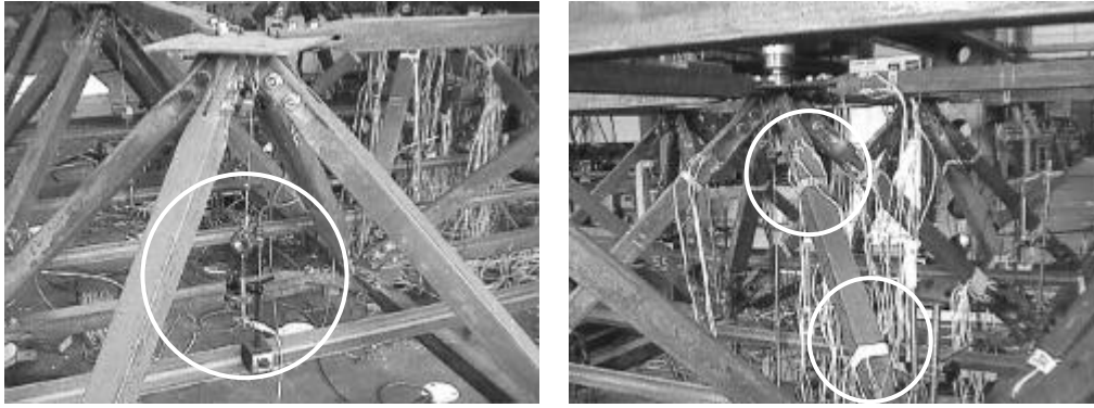
3. ábra: Induktív elmozdulásmérők és nyúlásmérobélyegek a kísérletben
