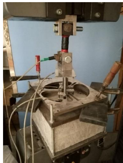
2.1. ábra: Leszorítás nélküli kihúzóvizsgálat sematikus és a megvalósult mérési összeállítása
