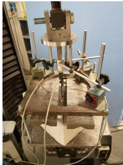
2.2. ábra: Leszorított kihúzóvizsgálat sematikus és a megvalósult mérési összeállítása
