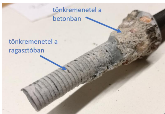
5.7. ábra: Kombinált kihúzódás epoxi ragasztó esetén hőterhelt betonban (Teszt1, h_{ef}=50 mm)
