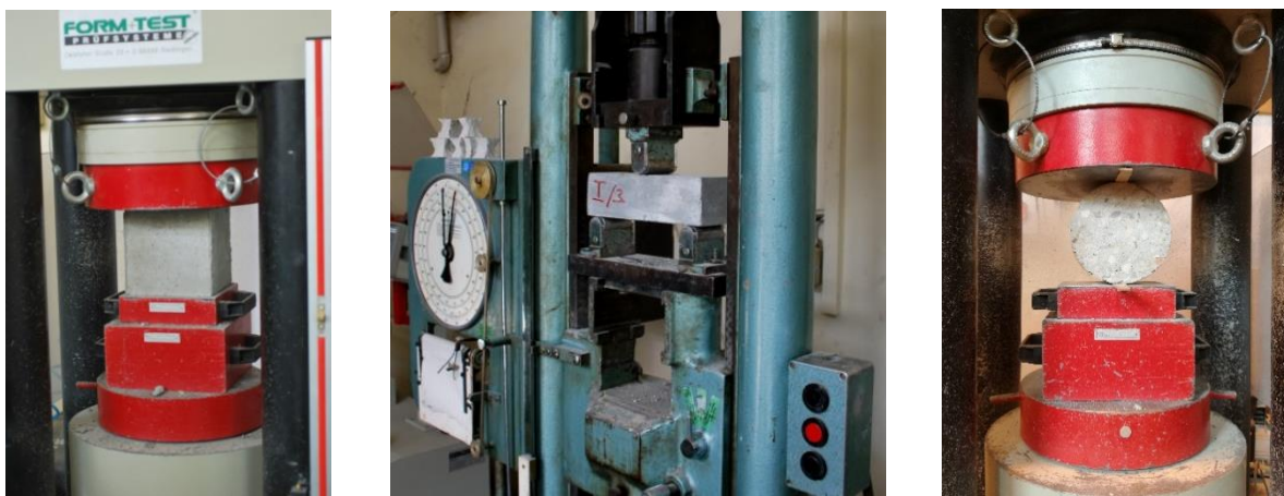
2.3. ábra: A betonkeverékekkel kapcsolatban elvégzett nyomószilárdság, hajlító-húzószilárdság és hasító-húzószilárdság vizsgálatok összeállítása
